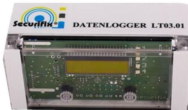
Die Securifix® hat mit dem Datenlogger LT03.01 ein Stapler Typ unabhängiges Mess-Prüfgerät entwickelt mit dem sich Leistungsdaten objektiv vergleichen lassen. Die Ergebnisse haben nicht nur die Fachwelt überrascht, sondern auch einige Großbetriebe.
